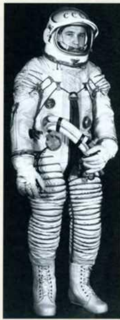
Общий вид скафандра «Беркут» без верхней телопозиционной одежды. В скафандре испытатель «Звезда» Виктор Ефимов.
